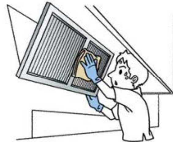
グリスフィルターの清掃
