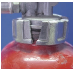
× キャップの破損
