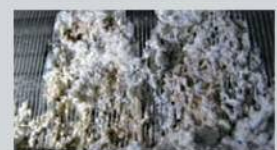
漏出したシリカが熱交換器に付着
