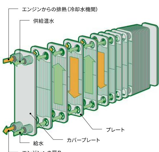
熱交換器に流れる冷却水に赤錆が混じることで熱交換器の効率が落ちてしまう。配管に錆が詰まり破裂する等のリスクがある。
