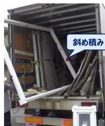
枠完成品出荷の場合、 トラックでの運搬時に斜め積みになる
