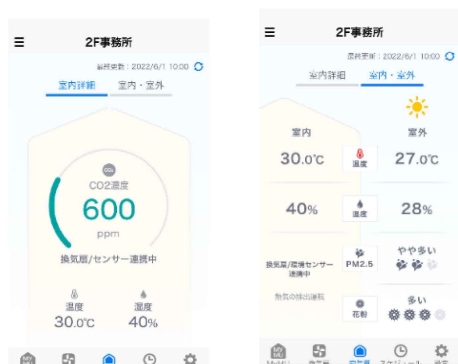
図2 室内環境の見える化画面イメージ (左が室内画面詳細、右が室内・室外画面)
