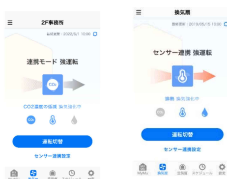
図3 換気機器の運転状況画面イメージ (左が CO 2 濃度低減運転、右が排熱運転)
