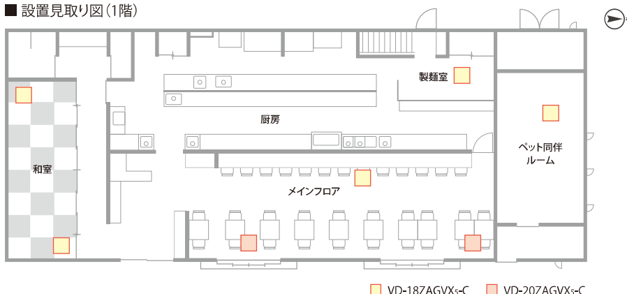
①小上がりの和室(約21㎡・天井高約2.1m)にはCO 2 センサー搭載換気扇を2台設置 ②製麺室にも1台設置③2階の高須会様事務所でも休憩室などに2台導入
