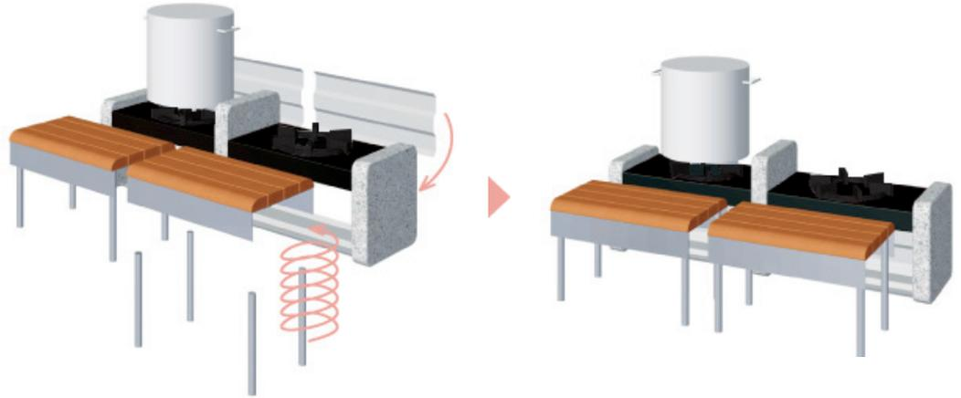
風受けパネルを背面、灰落しは底面、簡易脚部は取り外した座板に取り付けます。
